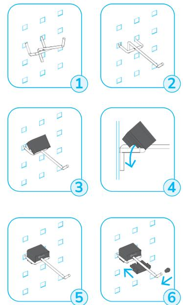
Il blocco di sicurezza ferma il gancio in posizione orizzontale e ne evita il movimento durante le operazioni di recupero/deposito utensili.
