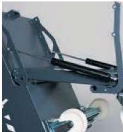
CILINDRO IDRAULICO PER BENNA
